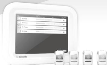
RaySafe i3は、放射線被ばく線量を抑えるための迅速な対処ができるよう、医療従事者の被ばく状況をお知らせする個人線量計システムです。
